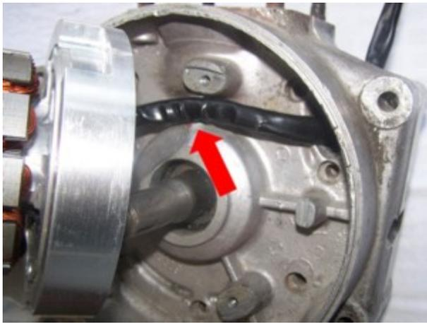
Wenn Sie sich für den "originalen" vorderen Ausgang entscheiden, müssen Sie dabei sehr vorsichtig sein. Gewährleisten Sie, daß das Kabel der neuen Lichtmaschine genau so verläuft, wie im Foto zu sehen. Beim Zusammenschrauben ist unbedingt darauf zu achten, daß hier nichts eingeklemmt wird.
