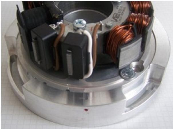
Schauen Sie sich die neue Statoreinheit an. Auf dem Außenumfang der Grundplatte werden Sie eine kleine rote Zündmarkierung finden.
