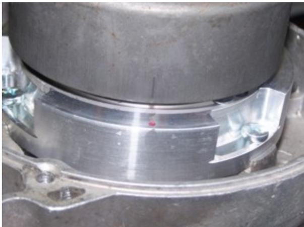
Nehmen Sie jetzt den Rotor wieder vorsichtig ab (ohne die Position der Kurbelwelle zu ändern) und stecken ihn wieder so auf, daß die Rotormarkierung über der auf der Grundplatte steht.
