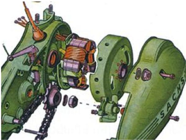
Ziehen Sie alle Kabel von der alten Lichtmaschine ab und entfernen Sie diese.
