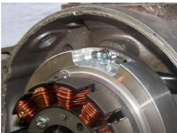
Um Justagemöglichkeiten in beide Richtungen zu haben, positionieren Sie die 3 Befestigungsschrauben mittig in den Langlöchern.
