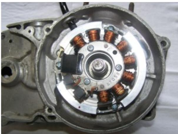
Setzen Sie die vormontierte Statoreinheit in das Motorgehäuse. Dabei soll die dicke schwarze Spule auf 9 Uhr zeigen. Wenn Sie den Stator aufsetzen, ziehen Sie gleichzeitig Stück für Stück am Kabelbaum. Schrauben Sie die Statoreinheit mit den 3 Schrauben M5 fest.
