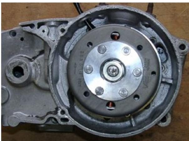
Befestigen Sie den Rotor vorsichtig mit der mitgelieferten Befestigungsmutter M12x1.
